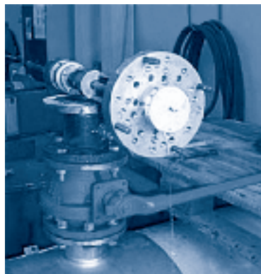
Abbildung 8-3 Anbohrmaschine, Ventil und zurückgezogener Ausschnitt
