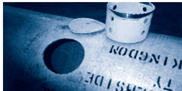
Abbildung 8-4 Alternatives Schneidwerkzeug mit engstehenden Zähnen
